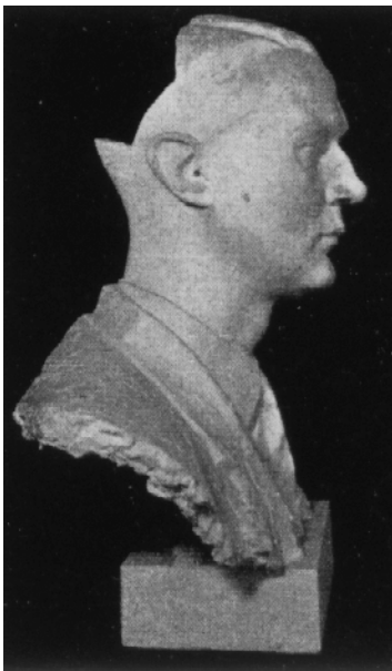
Figuur 4: Een gipsen afdruk van de Boer's hoofd, uit de beginperiode (ca. 1939) van de stereofonie en bedoeld als experimenteel kunsthoofd.
